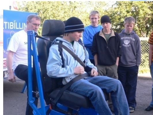
Προσομοίωση πρόσκρουσης με ζώνη (7kmh) - Belt Sledge (Γαλλία)
